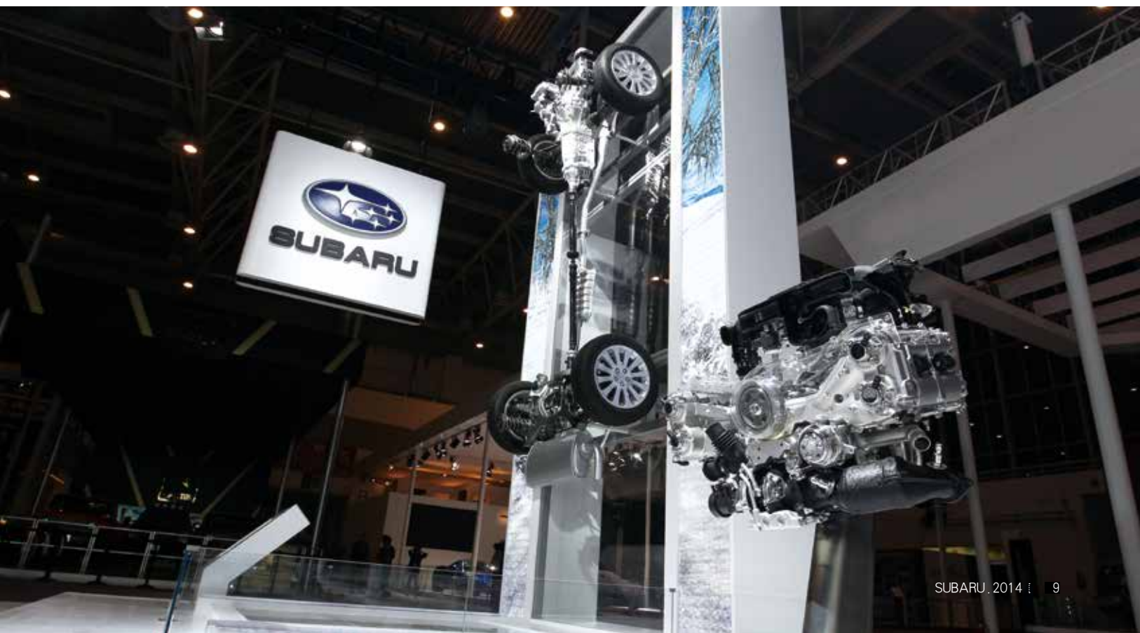
8—9、立体展示的斯巴鲁核心技术：左右对称全时四轮驱动系统（Symmetrical AWD）以及水平对置发动机（SUBARU BOXER）。
